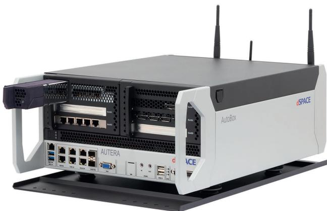
Bild 2: Die Speichereinheiten des AUTERA-Systems können während des Betriebs komfortabel gewechselt werden ohne das System neu starten zu müssen.
